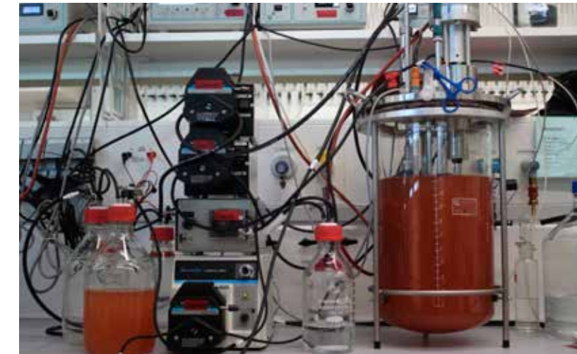
Een bioreactor waarin anaërobe anammoxbacteriën groeien.
